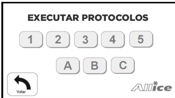
Após selecionar um dos protocolos pré-definidos (1,2,3,4,5) abasteça o reservatório com N<sub>2</sub> líquido pela metade e toque em **START**.
